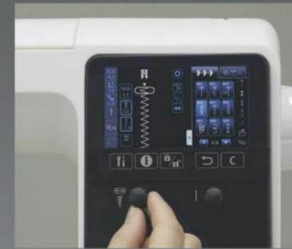
Réglage très facile de la longueur et largeur du point ainsi que de la position de l'aiguille grâce au bouton de réglage. Pendant la couture la modification de la largeur et longueur du point est possible.
